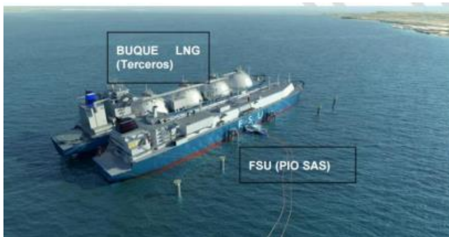
Figura 2.6 Esquema STS en zona de fondeo
