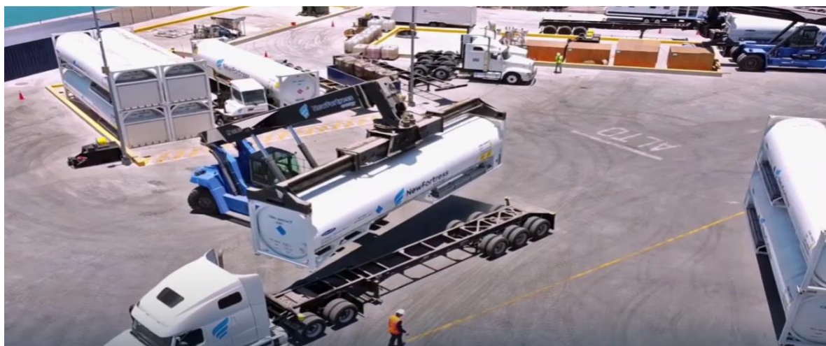
Figura 2.10 Esquema del descargue de isocontenedores.
