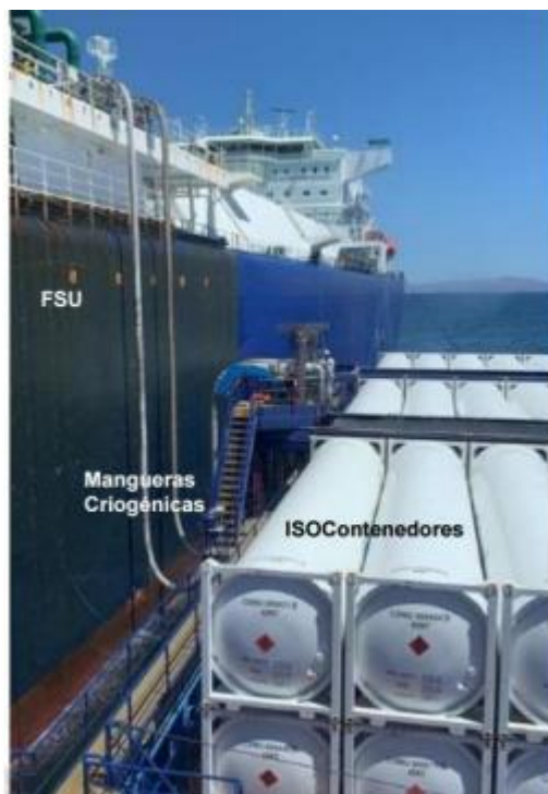
Figura 2.8 Transferencia con mangueras del FSU a la barcaza
